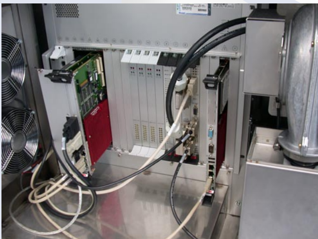
Die CompactPCI-CPU-Karte CP605 zur Steuerung des Laserbelichters entspricht im Wesentlichen der Standardausführung
