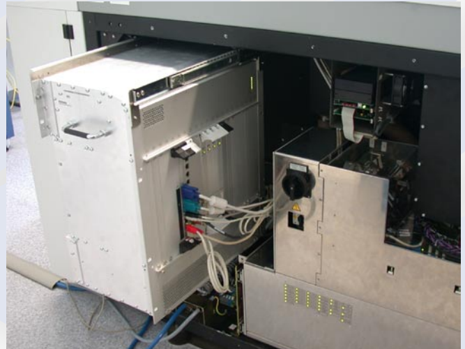
Im Hochleistungsscanner d-scan.20 der Anlage sind gleich zwei CPU-Karten CP605 von Kontron im Einsatz
