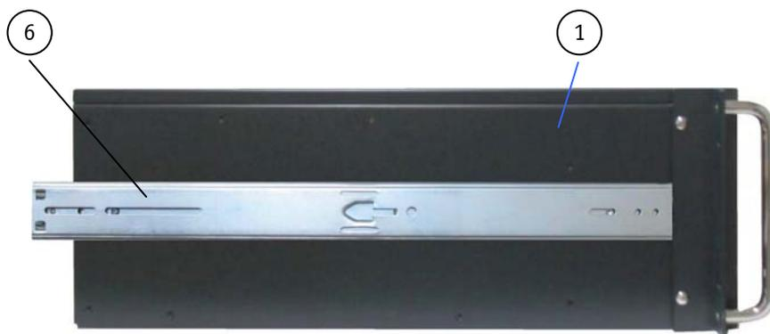
Abb. 51: KISS 4U V2-Plattform mit Teleskopschiene in eingefahrener Position
