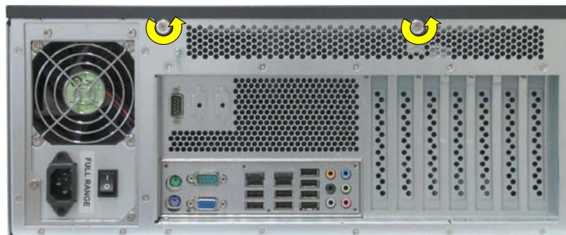
Abb. 29: Lösen der Rändelschrauben an der Rückseite
