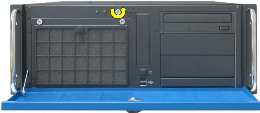
Abb. 28: Lösen der Deckel-Anziehschraube an der Frontseite
