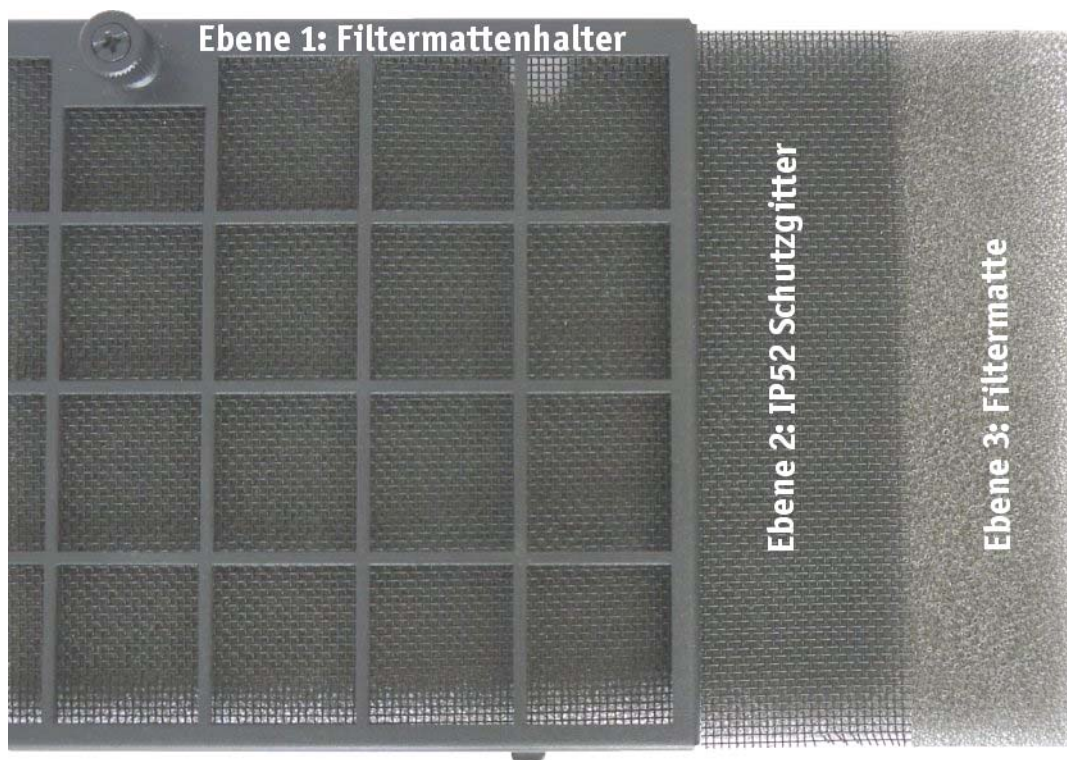
Abb. 39: IP52 Ausführung - Anordnung des Schutzgitters und der Filtermatte im Filtermattenhalter
