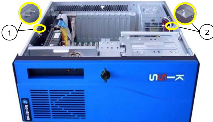
Abb. 21: Bolzen und Befestigungspunkt für Kartenniederhalter
