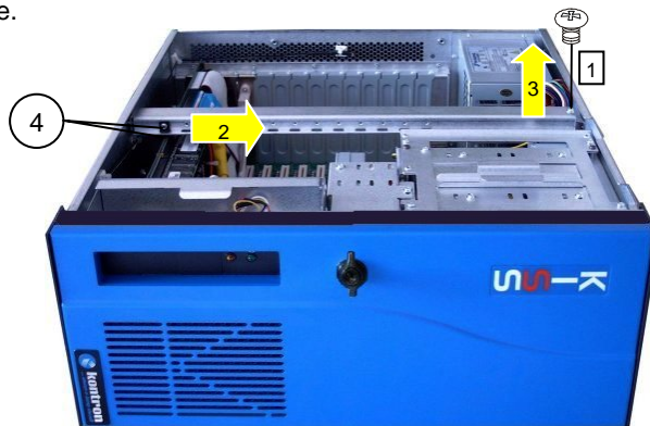
Abb. 20: Lösen der Befestigungsschraube und entfernen des Kartenniederhalters
