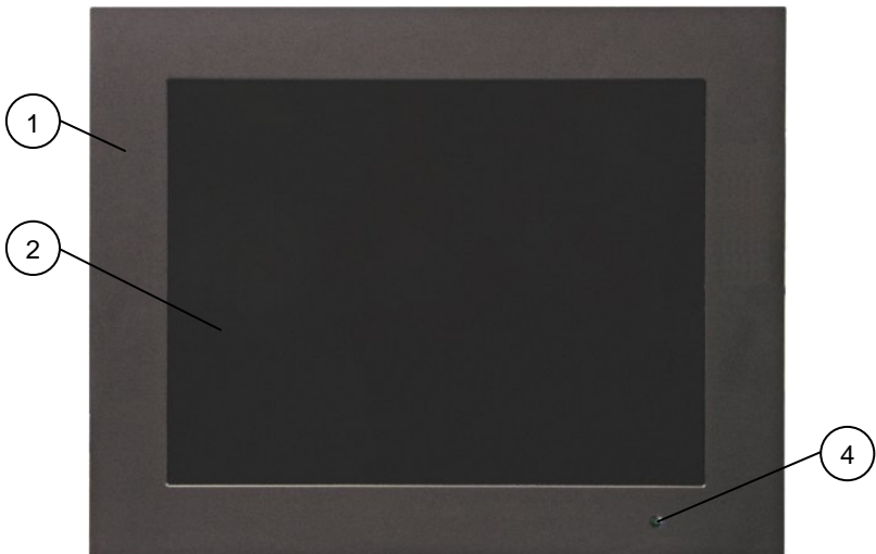
Abb. 2a: KFM21_e - mit frontseitiger „Status LED“ (wenn die OSD Menü-Tasten und der On/Off-Taster rückseitig, rechts angebracht sind)
