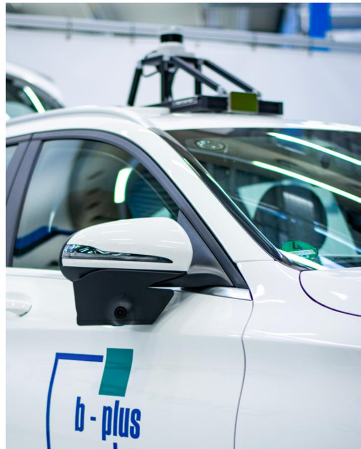
// Versuchsfahrzeug für autonomes Fahren
