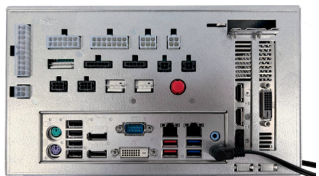
K-Box I/O Shield-Layout, vollständig auf die Anforderungen des Kunden zugeschnitten
